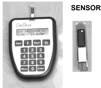
Figura 3-22 – Dosímetro digital utilizando transistores MOS.
