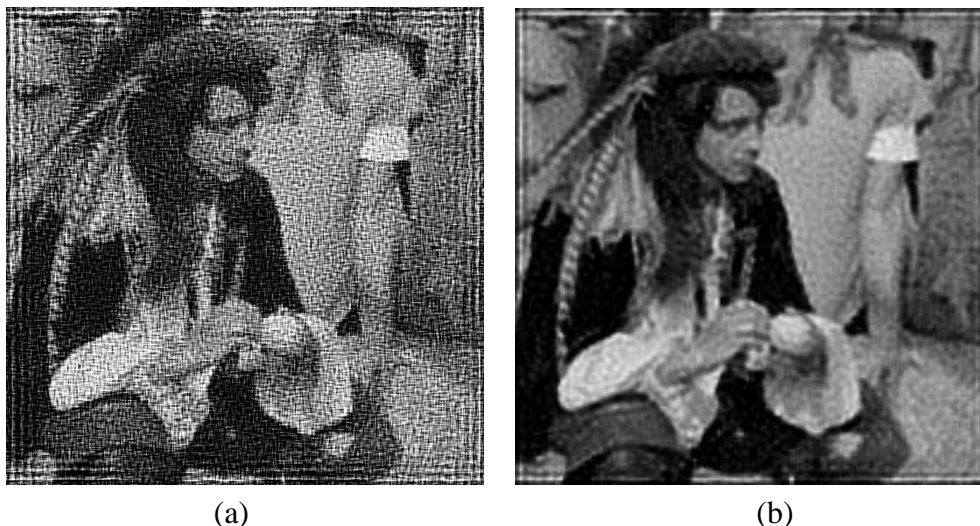
Figura 6.14: Exemplo 6.8.2 — (a) Restauração obtida pelo filtro de Wiener , sem as utilizar matrizes de autocorrelação e os espectros de energia da imagem original e do ruído, RSR = 5.73db; (b) Restauração obtida através do filtro de Lucy-Richardson , sem o pré-processamento da imagem degradada, RSR = 10.16db
