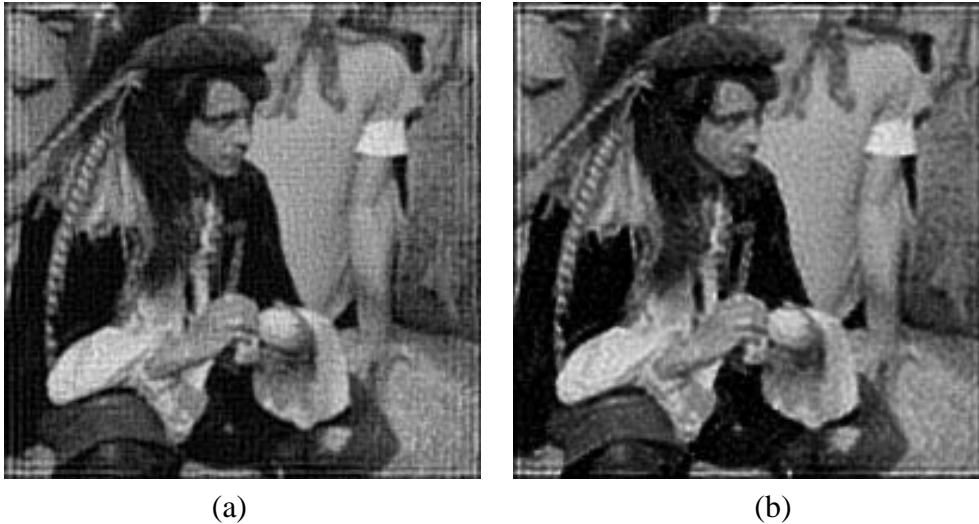
Figura 6.12: Exemplo 6.8.2 — (a) Restauração obtida pelo filtro de Wiener , utilizando as matrizes de autocorrelação e os espectros de energia da imagem original e do ruído, RSR = 14.14db; (b) Restauração obtida através do filtro de Lucy-Richardson , antes utilizando um filtro de mediana para suavização do ruído na imagem degradada, RSR = 13.02db
