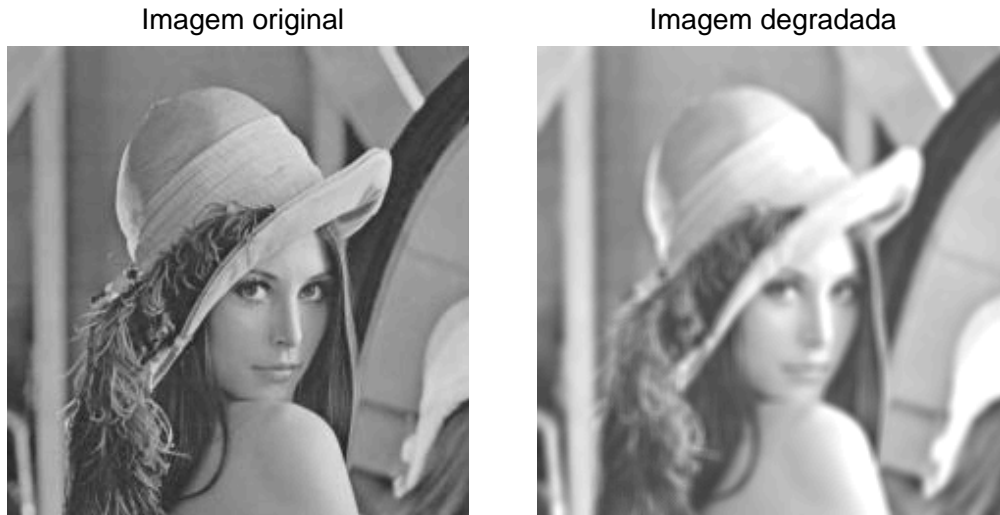
Figura 6.3: Imagem degradada por embaçamento, provocado pela aplicação da PSF dada em (6.1) sobre a imagem original
