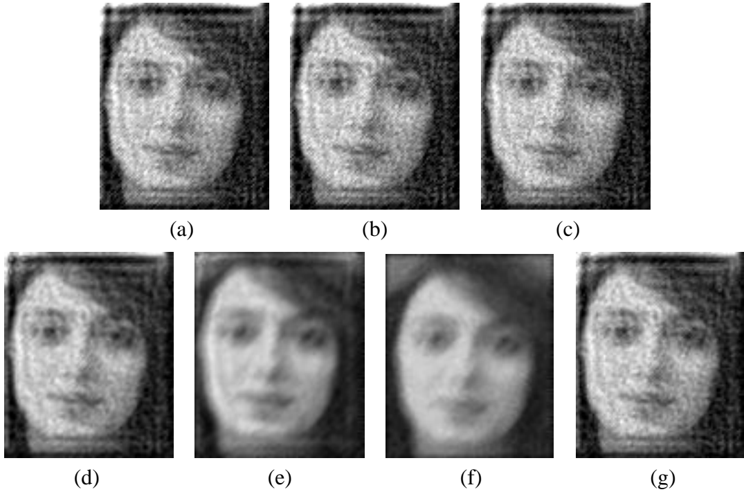
Figura 6.6: Exemplo 6.8.1. Restaurações obtidas pela implementação paralela do sistema gradiente (6.14) para diferentes valores de \lambda e utilizando 4 processadores— (a) \lambda = 10^{-6} , imagem restaurada com RSR = 9.62\text{db} e \Delta RSR = -8.48\text{db} ; (b) \lambda = 10^{-4} , imagem restaurada com RSR = 9.51\text{db} e \Delta RSR = -8.58\text{db} ; (c) \lambda = 10^{-3} , imagem restaurada com RSR = 9.66\text{db} e \Delta RSR = -8.43\text{db} ; (d) \lambda = 10^{-2} , imagem restaurada com RSR = 10.75\text{db} e \Delta RSR = -7.34\text{db} ; (e) \lambda = 10^{-1} , imagem restaurada com RSR = 12.70\text{db} e \Delta RSR = -5.39\text{db} ; (f) \lambda = 2.0 , imagem restaurada com RSR = 18.94\text{db} e \Delta RSR = 0.84\text{db} ; (g) \lambda determinado iterativamente através da equação (6.32), imagem restaurada com RSR = 10.54\text{db} e \Delta RSR = -7.64\text{db}
