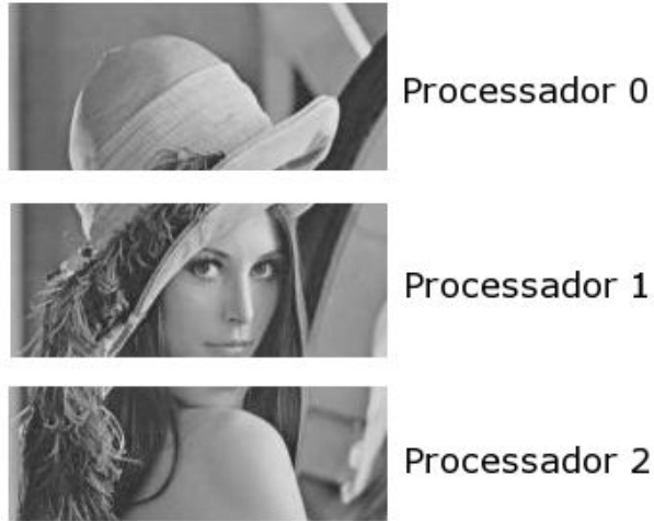
Figura 6.4: Particionamento da imagem para processamento paralelo através do sistema gradiente (6.14) utilizando três processadores, em que cada bloco é mapeado em um processador diferente
